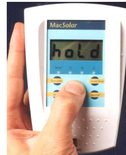
Fig. 5: Messung aktueller Werte mit dem MacSolar
